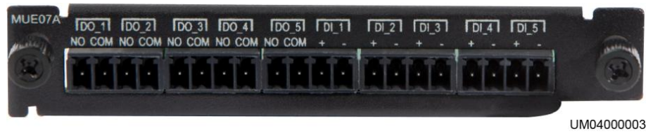
图4-20 干接点扩展卡面板示意图
