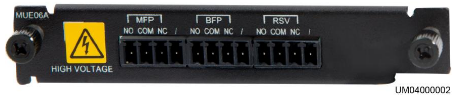
图4-19 反灌保护卡面板示意图
