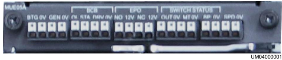
图4-16 干接点卡面板示意图
